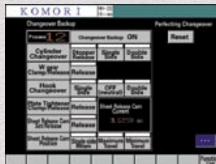
Touchscreen für vollautomatischen S/W-Wechsel
