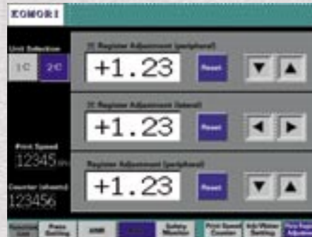
Steuerung der Registereinstellung
